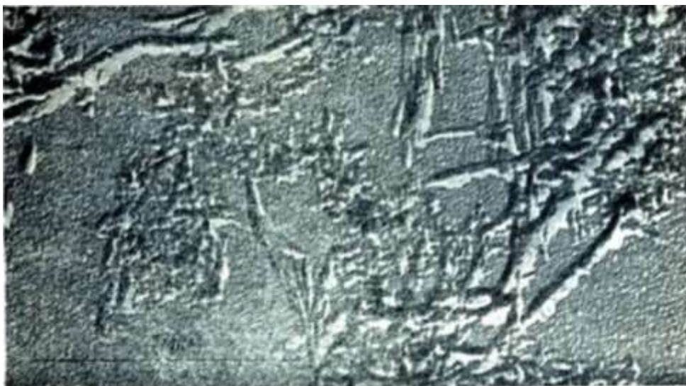
1.2.3.– расм. 100 кунлик пахта целлюлозанинг микрофибрилл “кристаллитлари” нинг энг зич соҳалари
